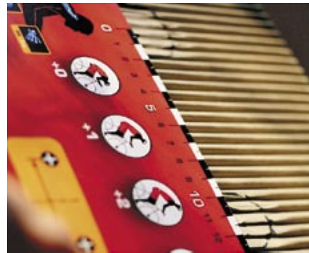
Messung zur Bestimmung der Sattelbreite: Die Sitzknochen haben sich deutlich eingedrückt...
